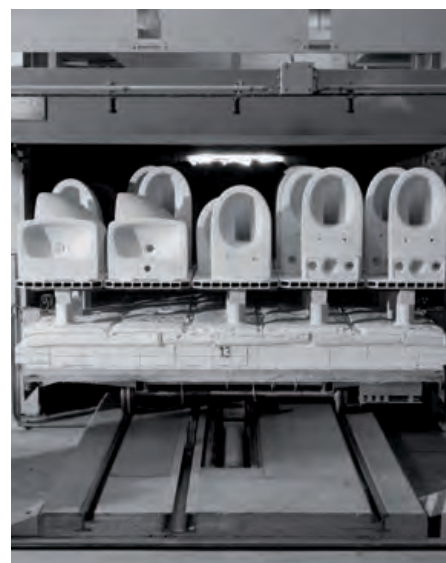
Beim Brand im über 1.200 °C heißen Tunnelofen schrumpft die Keramik um rund 12 Prozent.
